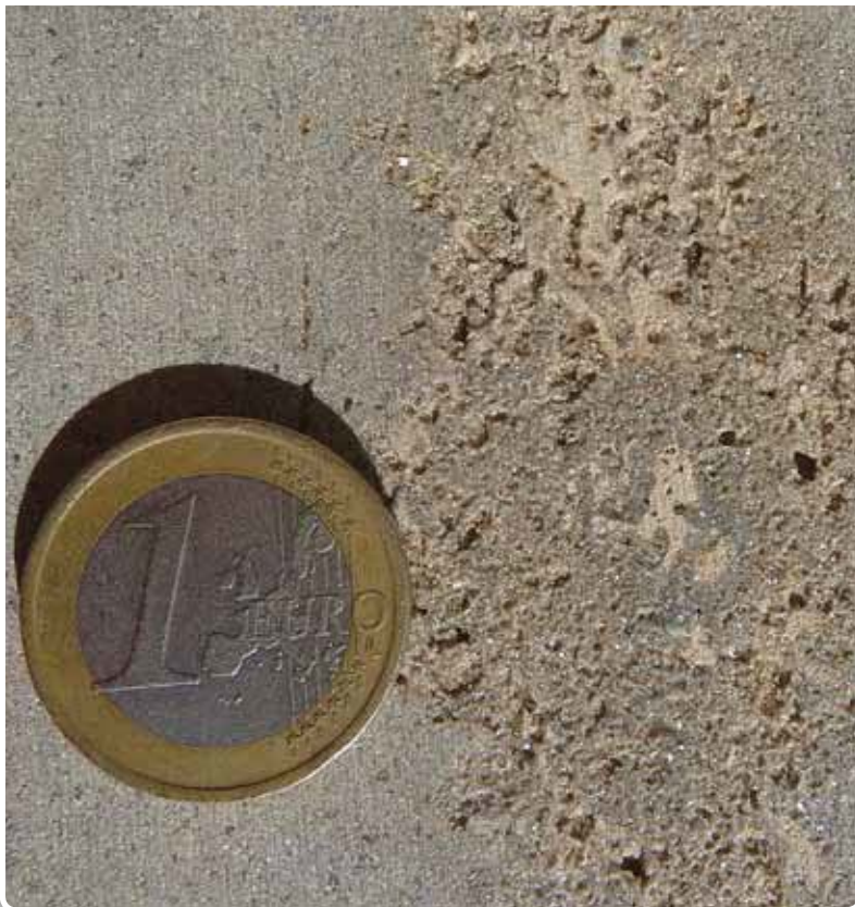
Bild 9 Dolomit einer Bodenplatte um die Basilika. Das Glitzern kleiner Dolomitmikrokristalle ist typisch für den Dolomit.
